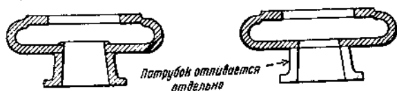
Фиг. 76. Улучшение конструкции с учетом литейной практики (W. W. Kerlin)
