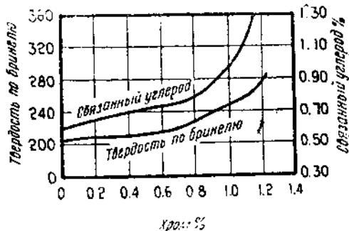
Фиг. 15. Влияние хрома на твердость и содержание связанного углерода в сером чугуне (Trantín)
