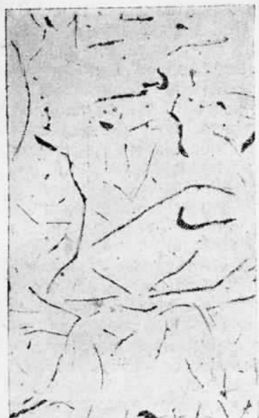
Фиг. 1. Чугун с крупным графитом. Не травлено. \times 100
